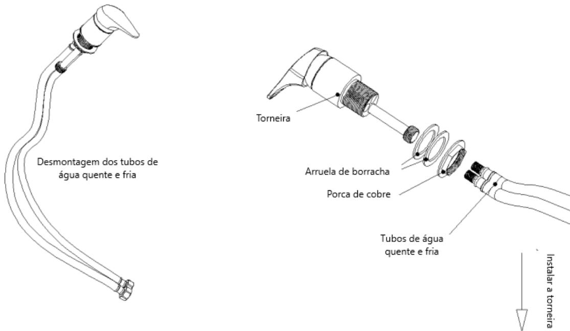
**Observação:** Os tubos de água quente e fria devem ser conectados ao orifício de instalação que fica sob a marca do seletor de água quente e fria
